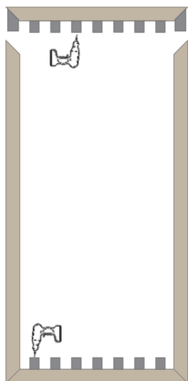
Atornillado de anclajes metálicos a marco.
