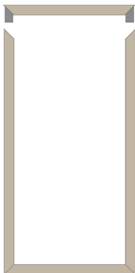
Armado de marco en caño metálico revestido en WPC.
