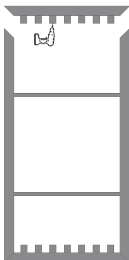
Atornillado de anclajes metálicos a marco.
